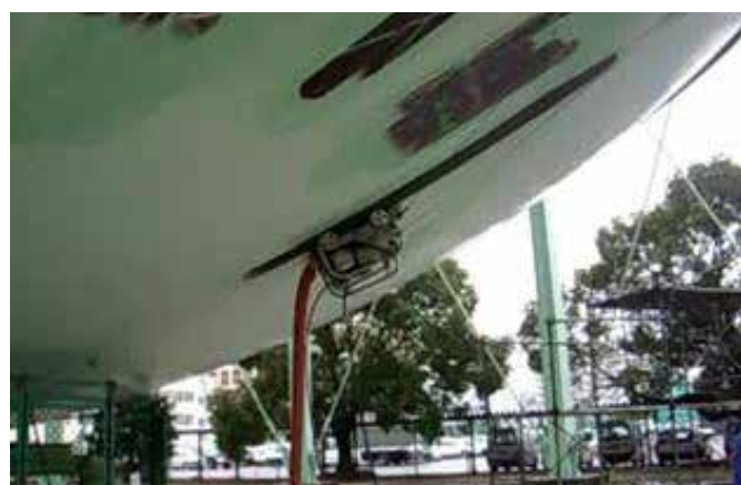
Удаление покрытия присасывающимся модулем, макс. давление 250МПа, подача 30 л/мин.
