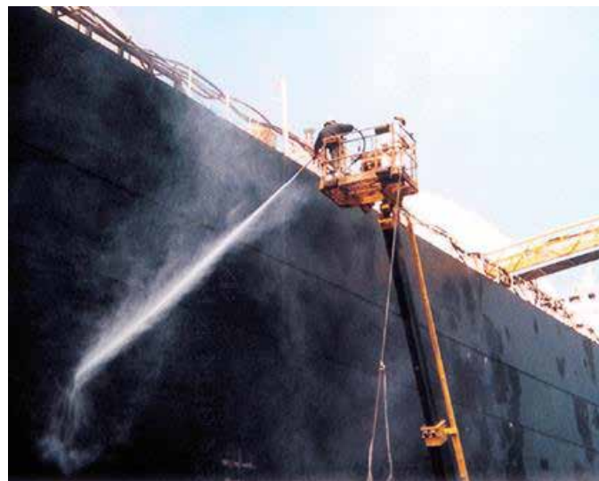
Зачистка корпуса судна от наростов с макс. давлением 12МПа. При зачистке поверхности судна макс. давление от 180 до 250МПа, в зависимости от типа краски.
